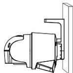
请用户按照说明书方式正确安装，禁止错误方向安装，否则存在因进水导致设备报废风险!
